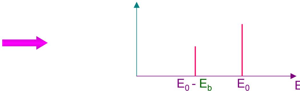
*N.B.* - causa **risoluzione finita** il picco di fuga è visibile in **NaI(Tl)** solo per  $E_0 < 100$  keV
