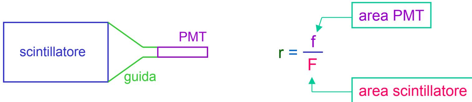
aumento di  $r$  per mezzo di geometrie più complicate (twisted): strisce separate di plexiglass attaccate all'estremità dello scintillatore e attorcigliate in modo da convergere nel PMT
